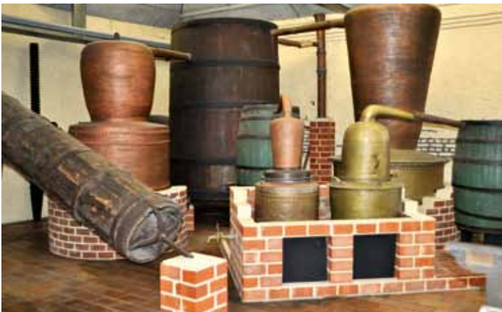
Een jeneverstokerij uit de achttiende eeuw zoals ze stond opgesteld omstreeks 1904 in de Gentse likeurhandel Van Thorenburg-Mestdagh. Op de voorgrond staat een kleine alambiek voor de productie van likeuren. Collectie Museum voor Industriële Archeologie en Textiel, Gent.
