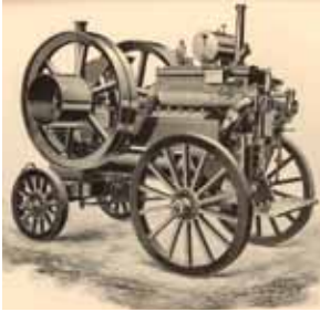
Spiritus-locomobiel van de Daimler-Motoren-Gesellschaft uit 1903. Bij maximale belasting gebruikte hij 0,5 à 0,6 liter gedestilleerde spiritus van 90 % vol per pk en per uur (Wender N., 1904).
