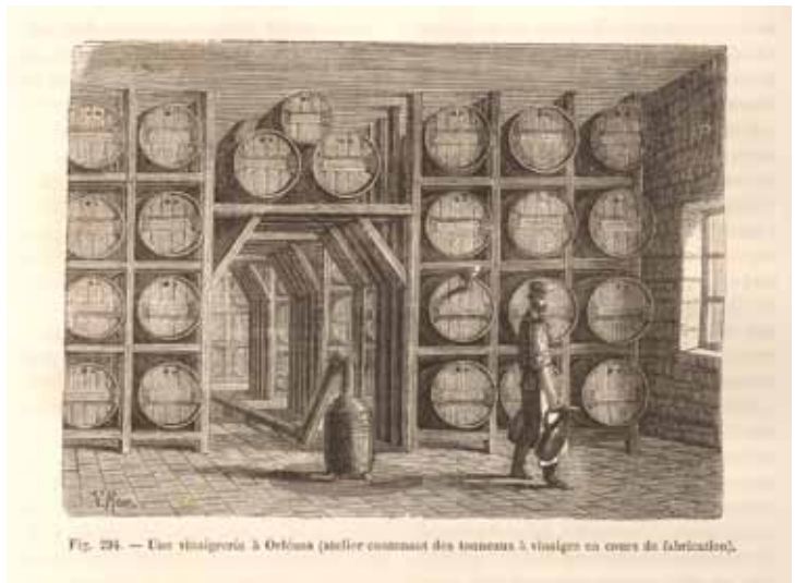
De azijnfabricatie volgens het Orléans-proces (Figuier L., s.d.).
